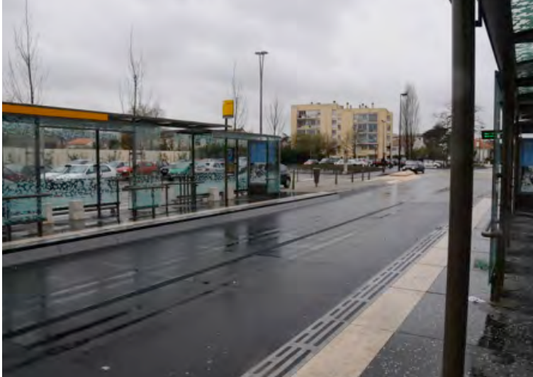
Busway Nantes – hållplatsutformning med hög kantsten och stort väderskydd
