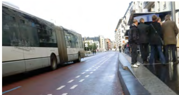
Hållplats i Rouen där också de vita linjerna syns som används för automatisk angöring med optisk styrning
