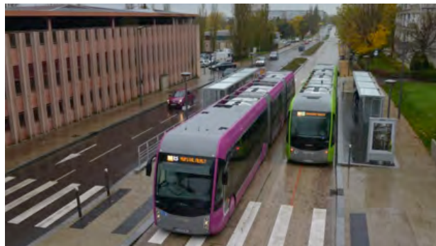
Hållplats i Metz där man kan se den röda hjälplinjen samt att plattformskanten ligger en bit ut i körbanan
