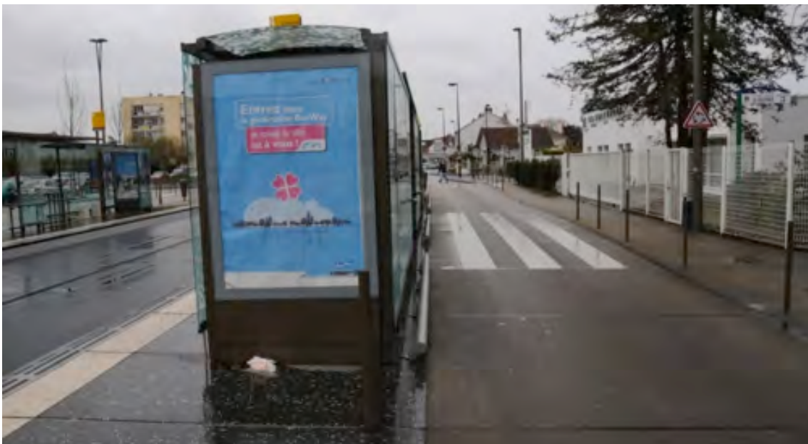
Smal körbana bakom hållplats i Nantes (Frankrike) – observera påkörningsskyddet bakom väderskyddet
