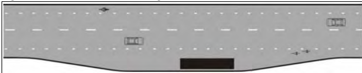
Figur 2.3. Fickhållplats. Källa: (Vägverket, 2004).
