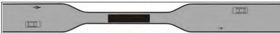
Figur 2.6. Timglashållplats. Källa: (Vägverket, 2004)
