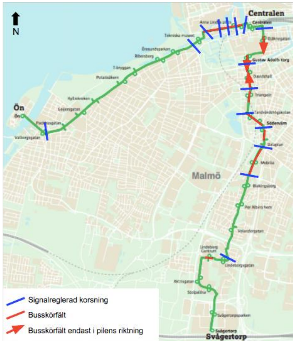
Figur 22. Signalreglerade korsningar samt busskörfält längs linje 7. Den gröna linjen visar linjesträckningen. Bild hämtad från Skånetrafiken (u.å c), modifierad av författare.
