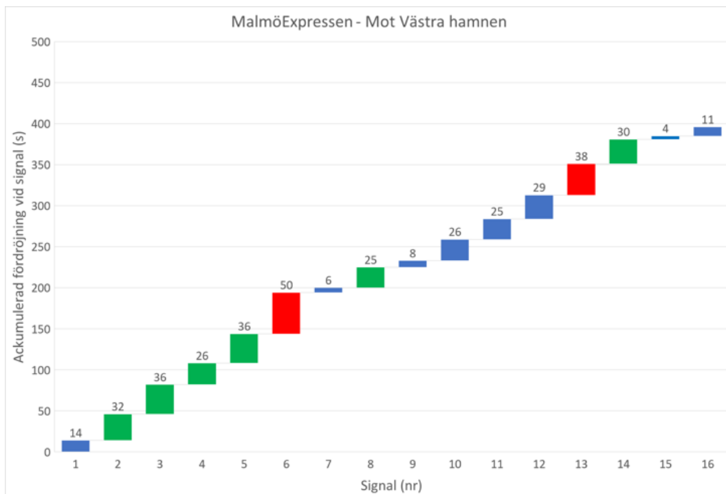
Figur 59. Fördröjningen i varje enskild signal längs MalmöExpressen i riktning Västra hamnen. De olika färgerna representerar olika signaler; blå: vanlig signal, grön: kollektivtrafiksinal och röd: signal i samband med hållplats.
