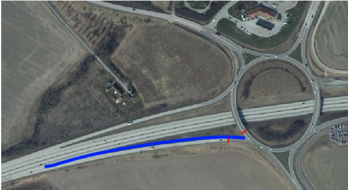
Figur 22. Skiss över föreslaget busskörfält vid Gårdstånga trafikplats. Den blå linjen avser föreslaget busskörfält och de röda markerar var signaler bör placeras för att ge bussen prioritet. Grundkarta: Lantmäteriet (2019).
