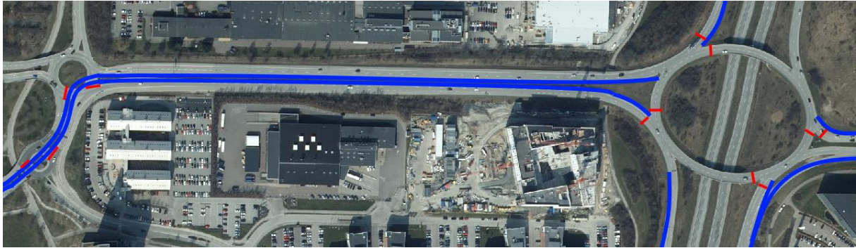
Figur 23. Skiss över föreslagna busskörfältslösningar kring Lund Norra. De blå linjerna avser busskörfält och de röda avser signaler som ska ge bussen prioritet. Grundkarta: Lantmäteriet (2019).
