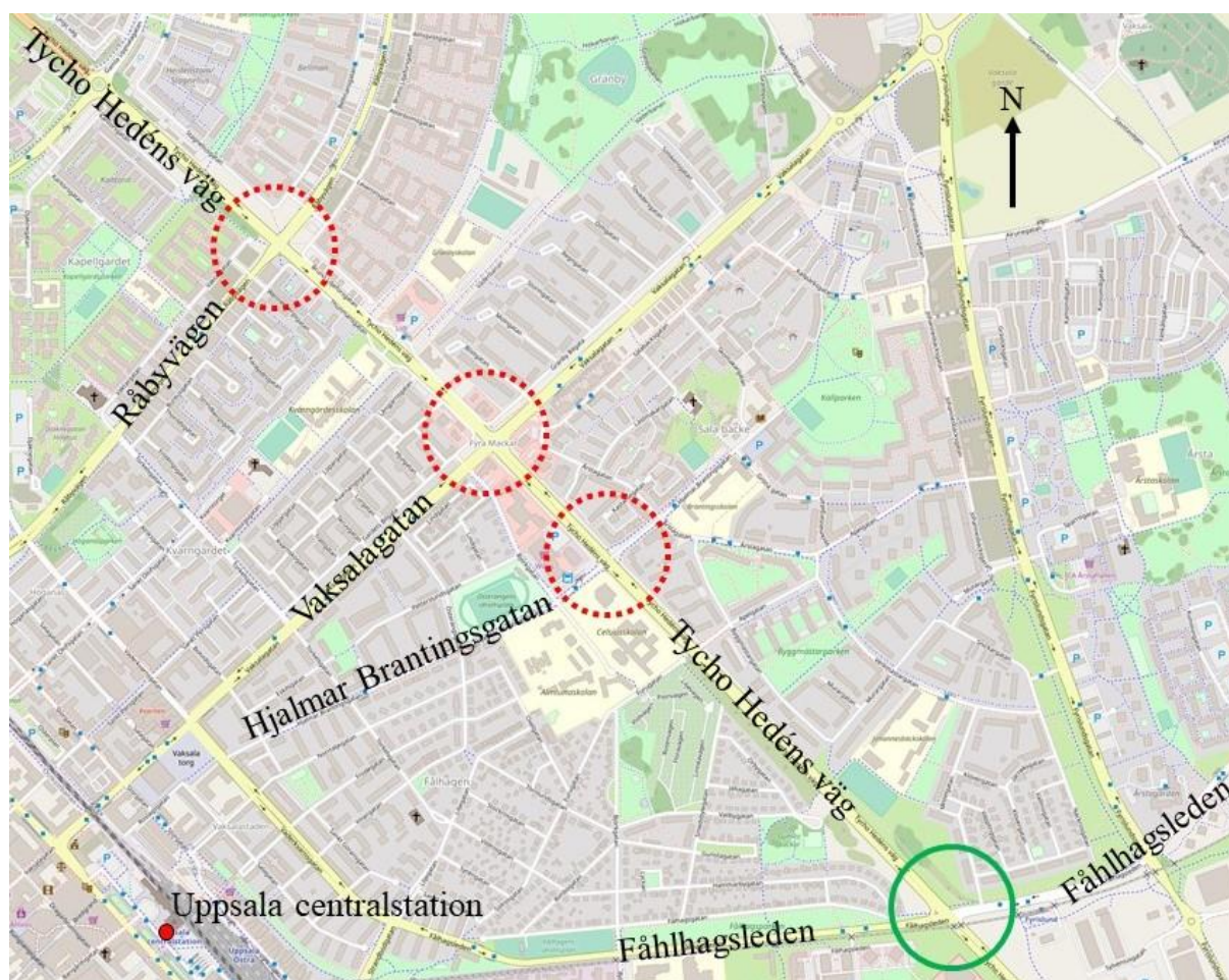
Figur 2. En del av Tycho Hedéns väg i Uppsala. Tre korsningar med planerad samordnad adaptiv styrning är streckat rödmarkerade medan korsningen Tycho Hedéns väg–Fåhlhagsleden planeras för oberoende adaptiv styrning och är heldraget grönmarkerad. © OpenStreetMaps bidragsgivare
