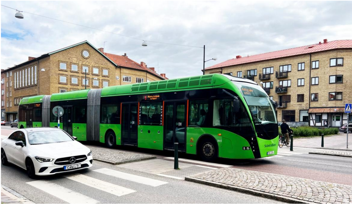
Figur 4. Amiralsgatan i Malmö. Tidigare bestod gatan av fyra körfält samt utrymme för gatuparkering och en smal mittrefug. När de två mellersta körfälten omvandlades till busskörfält minskades den totala körfältsbredden, vilket gav plats för två bredare trafikrefuger som ökar tryggheten för gående.
